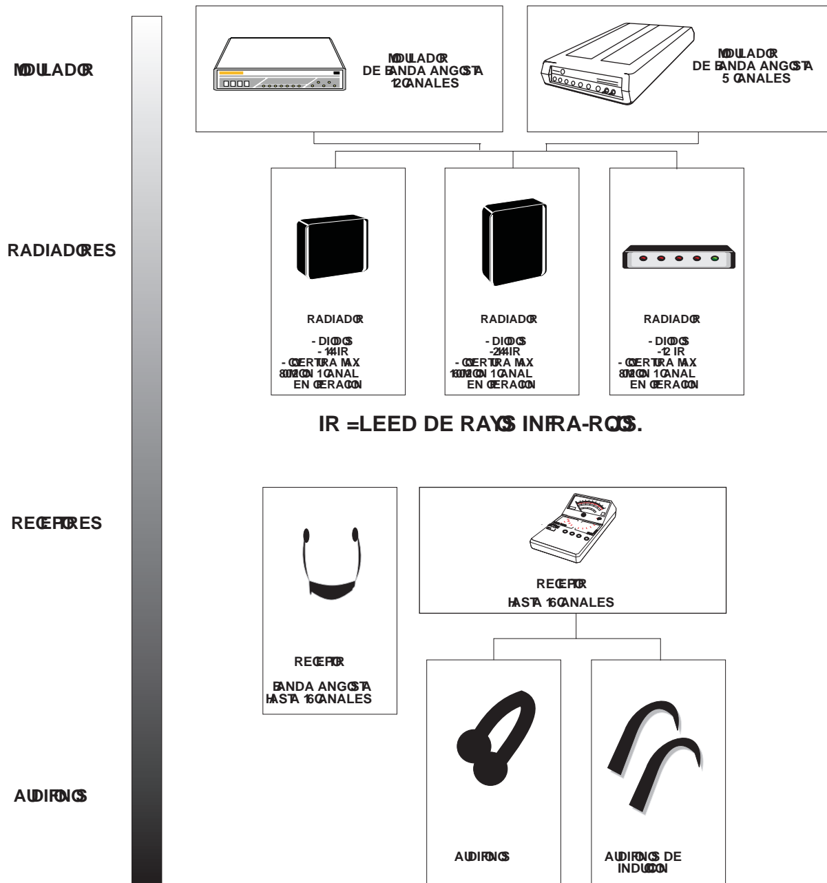
DIAGRAMA DE EQUIPAMIENTO EN BANDA ANGOSTA
