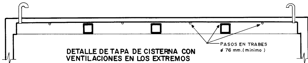
DETALLE DE REGISTRO PARA ACCESO A CISTERNA
